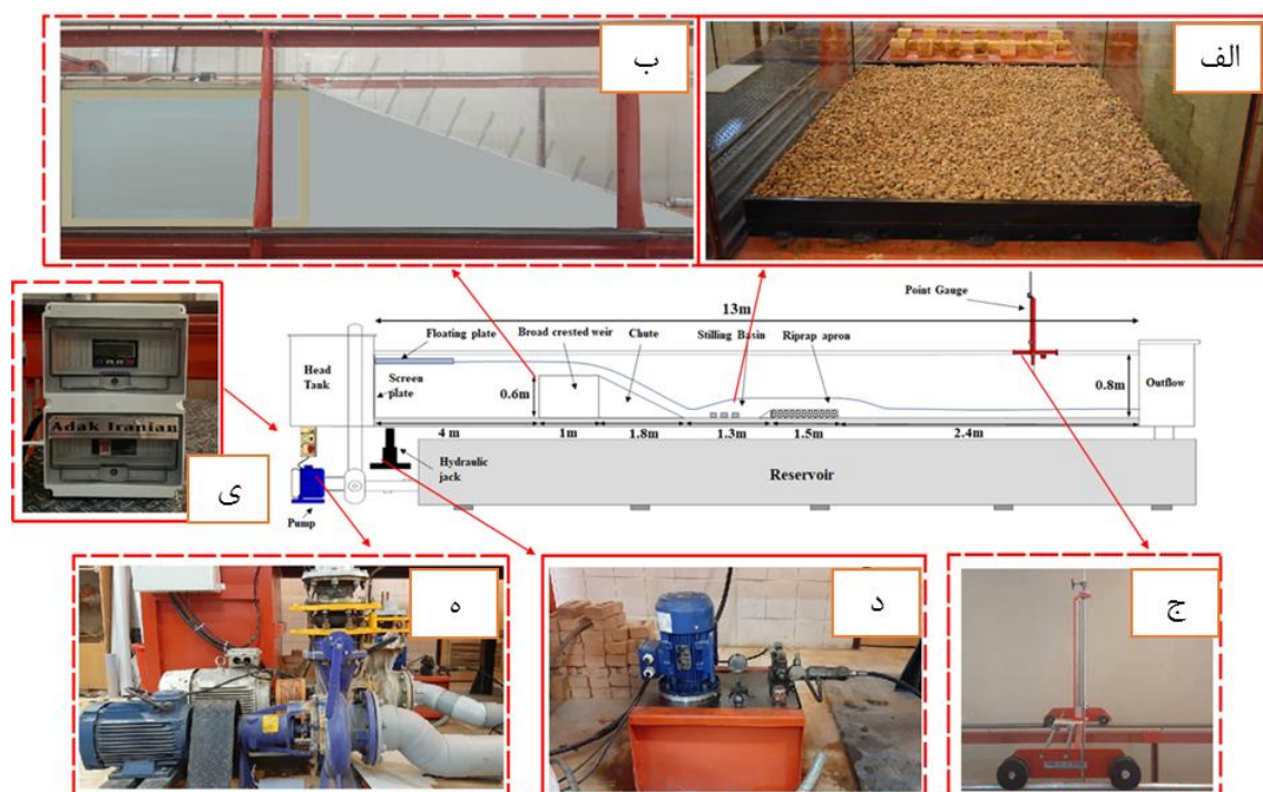
شکل ۱- طرح کلی از فلوم و مدل آزمایشگاهی: الف- حوضچه آرامش و باکس سنگریزه‌ای، ب- شوت، ج- عمق‌سنج، د- بالابر هیدرولیکی، ه- پمپ و ی- دبی‌سنج
